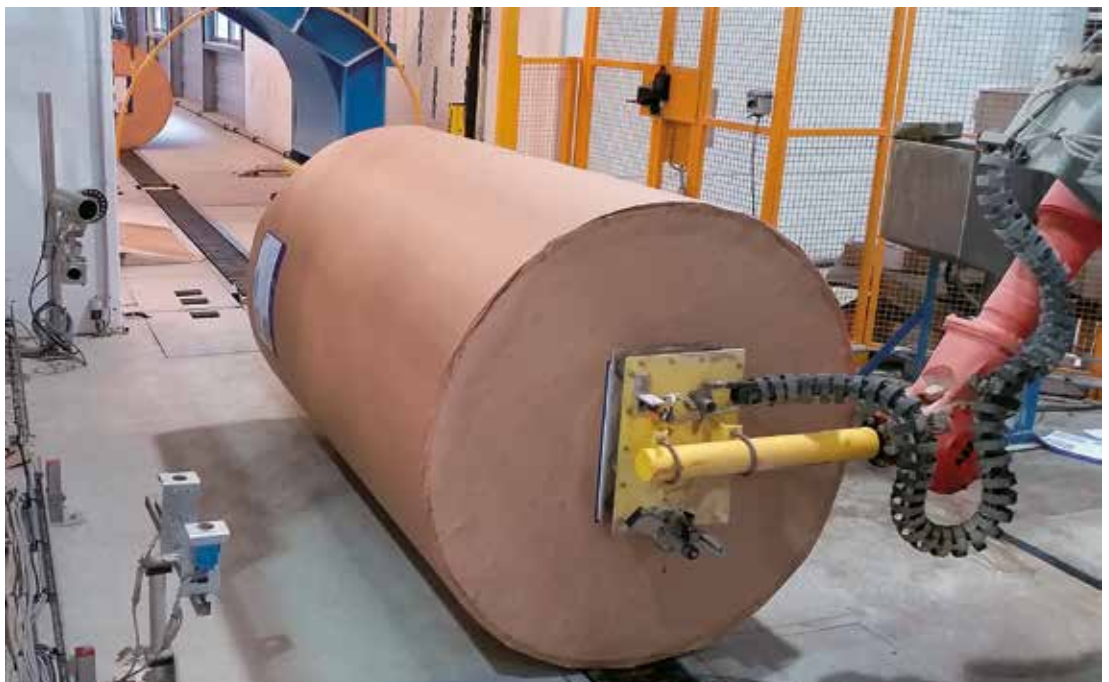
Bild 1. Bildverarbeitungssysteme (linker Bildrand) prüfen bis zu 5000 kg schwere Papierrollen auf Transport- oder Handling-Schäden.
